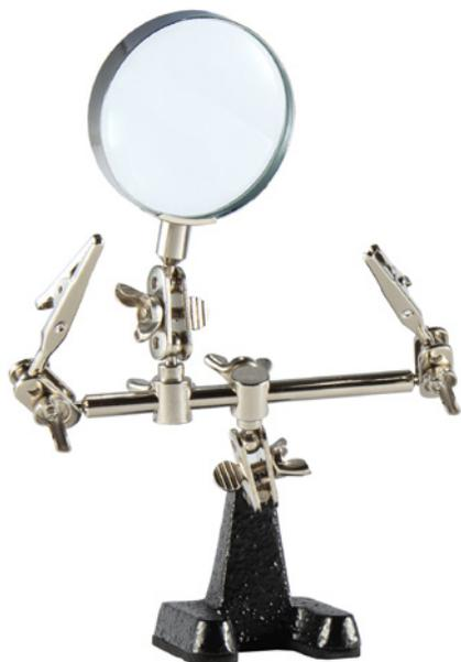
Libere sus manos y aumente su precisión y flexibilidad al soldar con el soporte de banco con brazos y lupa de Weller. Posicione los componentes fácilmente con las abrazaderas de tipo cocodrilo giratorias en 4 direcciones y amplifique 4 veces la vista de su área de trabajo para soldar como un experto.
