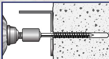
Inserte el Tornillo y Asegúrese de que penetre en el material base de 1" a 1-3/4". Use una punta Phillips #3 o una Llave de 5/16".
