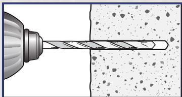
Perfore en el material base 1/2" más profundo que el empotramiento del anclaje, usando una broca de 3/16".
