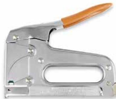
Cuenta con una carcasa de acero cromado, un mecanismo de carga trasera resistente a los atascos, un poderoso resorte helicoidal, un agarre acolchado, una guía de alambre ranurada para proteger los cables contra daños y una hoja curva para un rendimiento de grapado constante. Grapas: 3/8", 7/16", 9/16".
